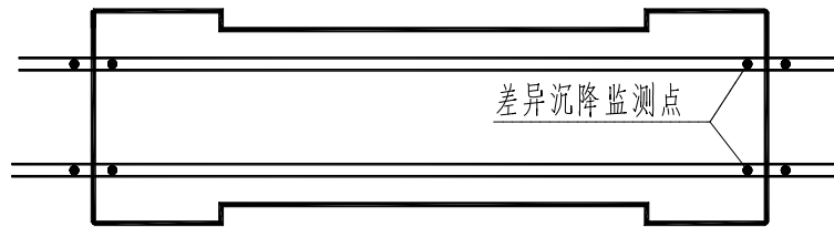
图 2-3 车站与隧道交接处结构差异沉降测点布置示意图
