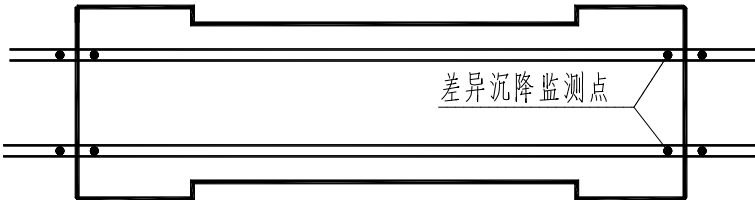
图 2-3 车站与隧道交接处结构差异沉降测点布置示意图
